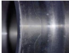
Hochvernetzte, elastische, in einer Plasma-unterstützten chemischen Gasphasenabscheidung (PECVD) aufgebraute Schichten reduzieren die Reibung in Kugellagern, schützen diese vor Korrosion und erleichtern deren Reinigung.
