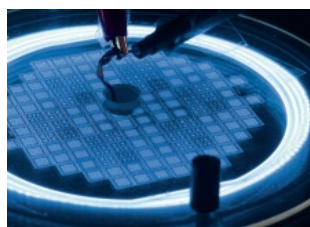
Titelbild 4/09: Behandlung eines strukturierten Siliziumwafers mittels Local PlasmaTreatment (siehe Artikel ab Seite 6).
