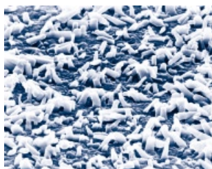
Titelbild 3/09: REM-Aufnahme einer mit Hochleistungs-Puls-Magnetronzerstäubung (HiPIMS) abgeschiedenen Indium-Zinnoxid-Schicht (Fraunhofer-Institut IST, Braunschweig).
