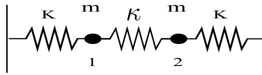
$K$  und  $\kappa$  seien die Federkonstanten der abgebildeten Federn,  $m$  die Masse der Teilchen (Massenpunkte).  $x_1$  und  $x_2$  sei die Auslenkung beider Teilchen aus der Ruhelage. Am Massenpunkt 1 wirke zusätzlich eine Reibungskraft  $F_R = -m\gamma\dot{x}_1$  sowie eine periodische Antriebskraft  $F_A = m \sin(\omega t)$ .
