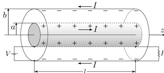
Dies führt zu einem Stromfluss mit Stromstärke  $I$ . Darüberhinaus lädt sich das äußere Kabel homogen mit der Ladung  $\lambda$  pro Länge und das innere Kabel mit der entgegengesetzten Ladung auf.
