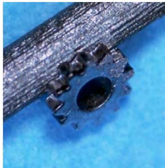
Abgeformte Strukturen aus WC/Co-gesintert 160µm Zahnrad (Fe-gesintert) Vergleich mit 0,5 Bleistiftmine Höhe - Aspektverhältnis 8:1
